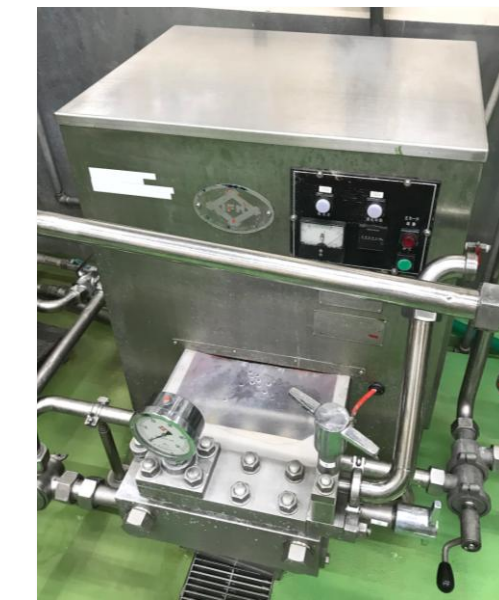
高圧ホモジナイザー 最大圧力20Mpa
